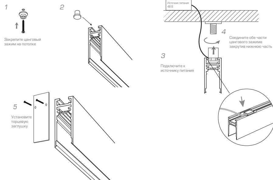
**!** Суммарная мощность светильников, устанавливаемых на шинопровод (соединенную между собой схему), не должна превышать 55 Вт с блоком питания 60 Вт, и 135 Вт при блоке в 150 Вт.
