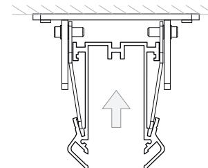
**3** Закрепите профиль на кронштейне саморезами. Отрегулируйте нужную высоту и затяните болты с помощью шестигранка.
