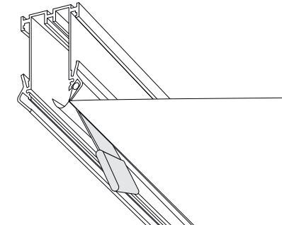
**6** Подключите и установите магнитный шинопровод в основной профиль
