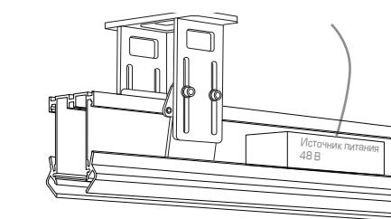
**5** Можете начинать установку натяжного потолка. С помощью специального шпателя заправьте ткань в отверстия в профиле
